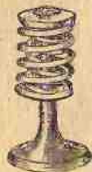
Рис. 51. Клапан с пружиной в собранном виде
