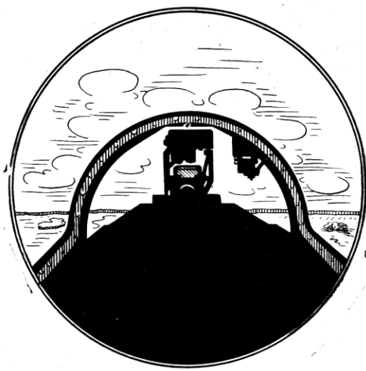
Рис. 6. Положение передней части фонаря кабины относительно горизонта в наборе высоты
