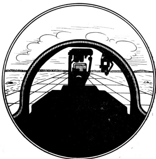
Рис. 17. Положение передней части фонаря кабины относительно горизонта в конце вывода из бочки
