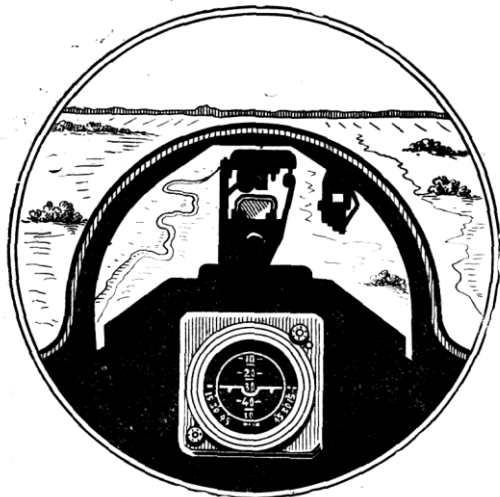
Рис. 22. Положение передней части фонаря кабины относительно горизонта при пикировании с углом 30^\circ
