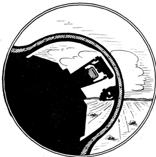
Рис. 13. Положение передней части фонаря кабины относительно горизонта на боевом развороте
