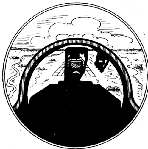
Рис. 9. Положение передней части фонаря кабины относительно горизонта на снижении после четвертого разворота
