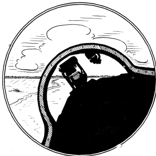
Рис. 8. Положение передней части фонаря кабины относительно горизонта на втором развороте
