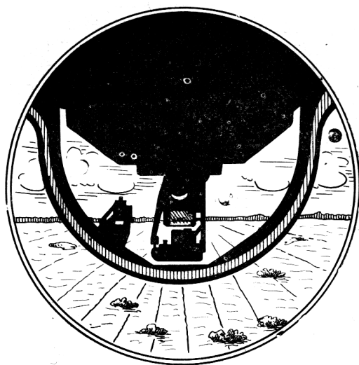
Рис. 16. Положение передней части фонаря кабины относительно горизонта при выполнении бочки (самолет в положении «вверх колесами»)
