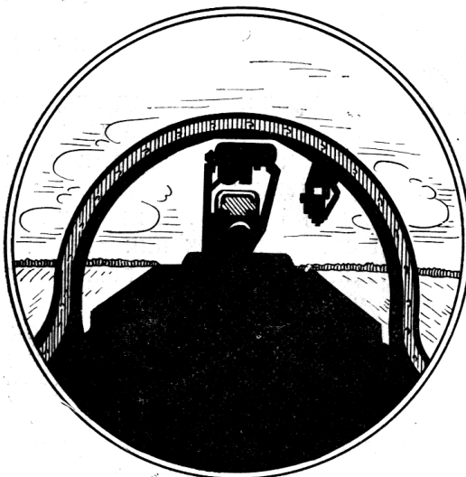
Рис. 15. Положение передней части фонаря кабины относительно горизонта перед выполнением бочки (угол кабрирования 10-15°)
