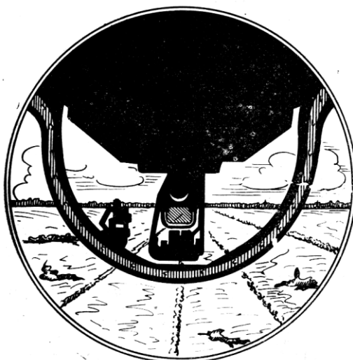
Рис. 19. Положение передней части фонаря кабины относительно горизонта в верхней точке полупетли
