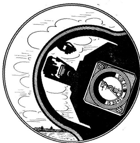
Рис. 21. Положение передней части фонаря кабины относительно горизонта при повороте на горке (момент уборки оборотов двигателя)
