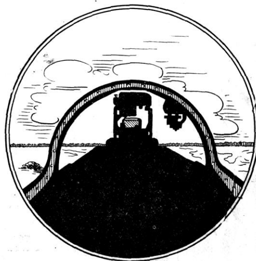
Рис. 5. Положение передней части фонаря кабины относительно горизонта при разбеге: а – в начале разбега, б – с поднятым передним колесом.
