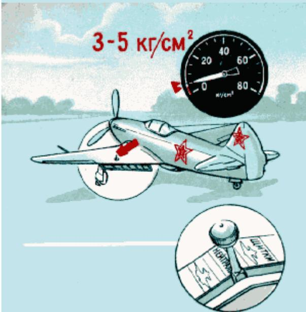
Проверить работу механизма выпуска щитков и исправность сигнализации. Щитки могут свободно выпускаться и убираться при давлении воздуха 3-5 кг/см<sup>2</sup>.
