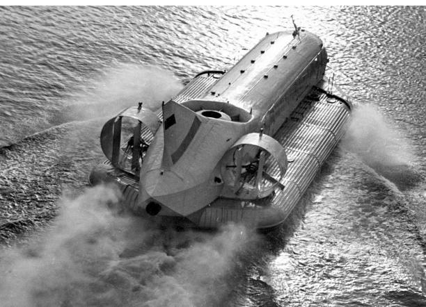
Рис. 3. Пассажирское судно «Сормович». На фото запечатлён момент, когда вентилятор выключен, аппарат переходит из парящего режима в водоизмещающий
