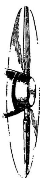
Рис. 86. Лопасти под нулевым углом установки. Самый легкий винт. Тяги не создает.
