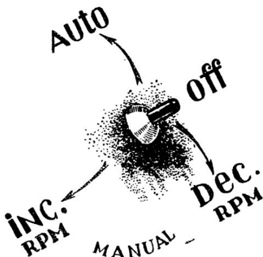
Рис. 42. Избирательный переключатель электромеханического винта.
